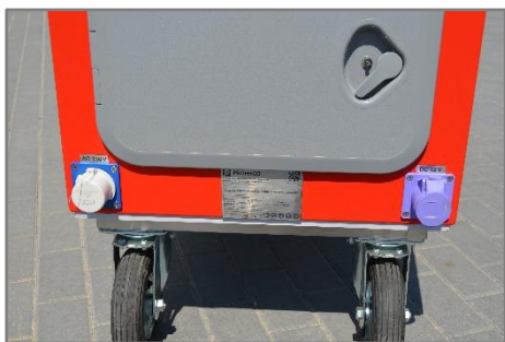
Gniazda ładowania i zasilania AC 230V, DC 12V zlokalizowane na zewnątrz.
