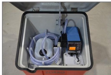
W jednej komorze zlokalizowana pompka dozująca, wąż oraz zbiornik.
