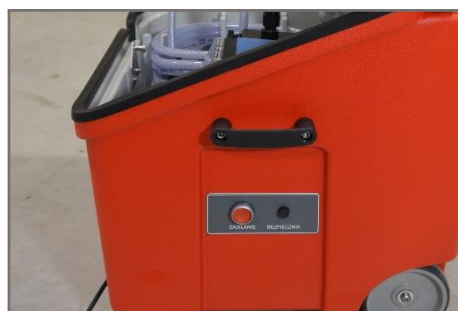
Panel sterowniczy posiada wyłącznik główny oraz bezpiecznik.
