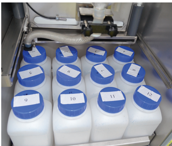
Dozowanie w układzie XY - bezpośrednie dozowanie próbek - wykorzystana cała przestrzeń komory
