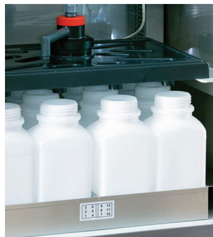
Dozownik kołowy z tacką pośredniczącą - konieczność mycia i wymiany tacki!
